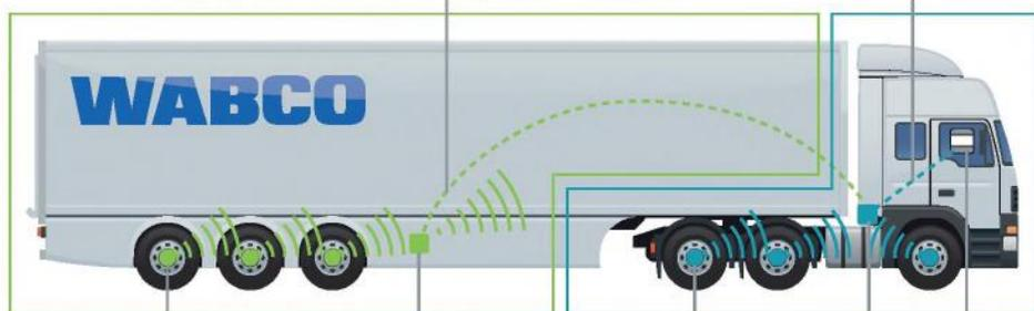
КОЛЕСНЫЙ МОДУЛЬ ECU ПРИЦЕПА КОЛЕСНЫЙ МОДУЛЬ ECU ГРУЗОВИКА ДИСПЛЕЙ
