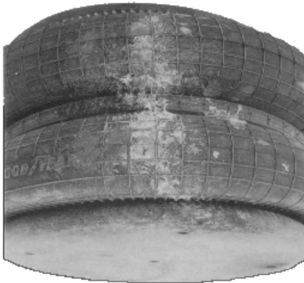
*Разрушение баллона вызвано химическими веществами, которые с течением времени "проедают" отверстия в резине.*
