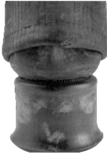
*Износ баллона возникает из-за постоянного контакта постороннего предмета с резиной, что приводит к образованию отверстия.*
