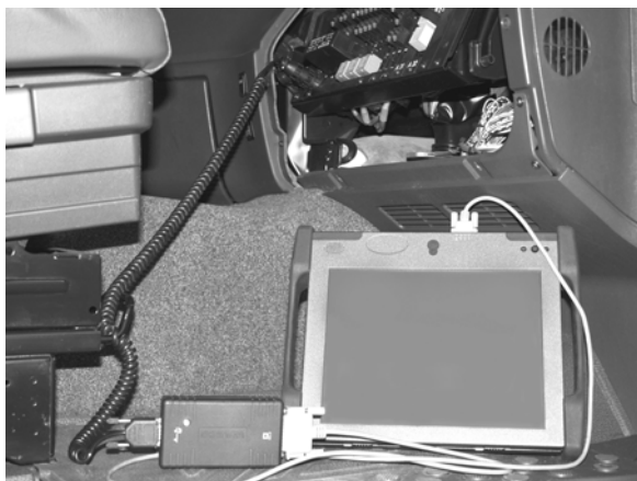
Рис. 39: Подключение диагностического ПК к транспортному средству.
